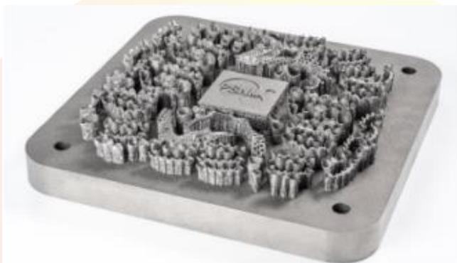
图 6 选区激光打印 TC4 在牙科领域的应
